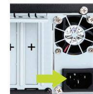
Observação: Verificar se a rede elétrica está de acordo com a faixa de operação da fonte. Verificar também se a tomada possui aterramento para uma boa proteção elétrica do equipamento.
