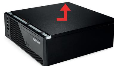
4. Nos pontos indicados com as setas vermelhas, solte as travas para a retirada do frontal do gabinete. Levante para cima a bandeja com as baias dos dispositivos.
