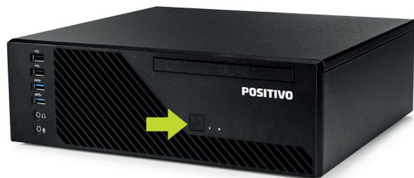
5. Acionar os botões liga/desliga do computador e do monitor, pressionando uma vez cada um dos botões. Se o monitor for LCD, pode ser utilizado o recurso autoajuste da imagem, pressionando o botão dessa função no monitor para ajustar a imagem à área visível da tela. Veja mais detalhes no manual do monitor. A função de modo espera (standby) do computador pode ser ativada ao ser pressionado o botão liga/desliga.
