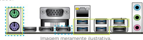
2. Conectar o cabo VGA, HDMI ou Display Port que acompanha o monitor na respectiva saída do microcomputador como indica a figura.
