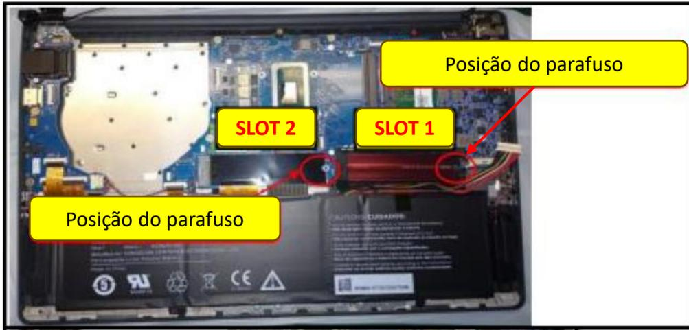
2. Para instalar um SSD, posicione o SSD no slot na posição diagonal e em seguida fixe o parafuso. Sobre o SSD posicione o thermal pad.
