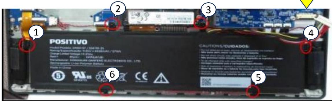
2. Para instalar uma bateria, posicione a bateria no local correto em que as 6 torres de fixação dos parafusos estejam visíveis. Fixe os 6 parafusos. Conecte na placa-mãe e cole a fita de acetato sobre o conector.
