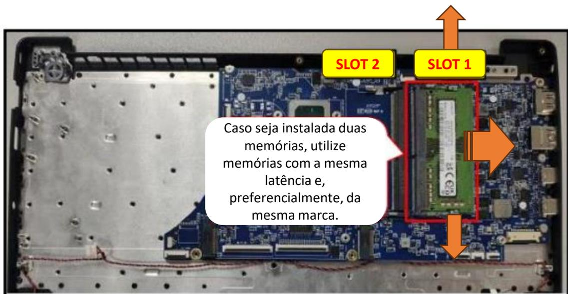
2. Para instalar uma memória, insira a memória no slot na posição diagonal. Em seguida, pressione para baixo até que ambas as travas metálicas sejam acionadas.
