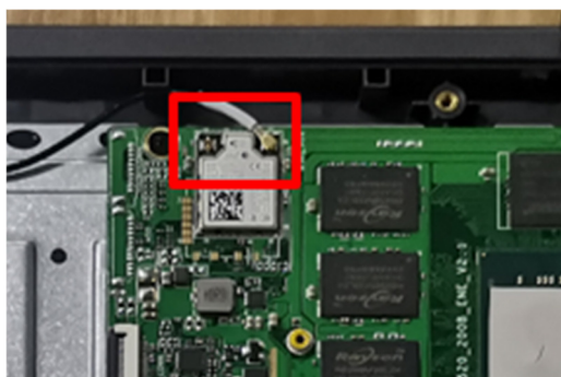
Cabo antena a ser removido
